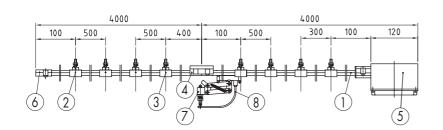
(1) MULTI-POLE INSULATED CONDUCTOR RAIL
